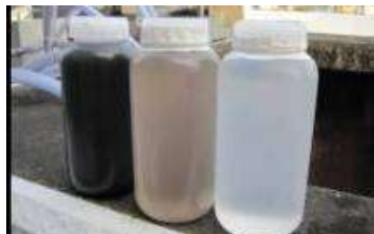
膜濃縮水、原水、處理水
